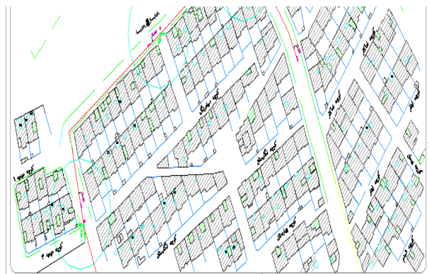
شکل (۱): نمونه ای از نقشه اطلاعات GIS Ready لوله های شبکه توزیع شامل قطر، عمق و جنس لوله شهر همدان
