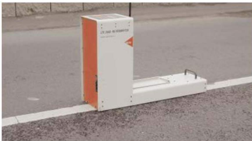
شکل ۳-۶: یک نمونه بازتاب سنچ خطکشی
