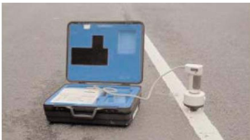
شکل ۳-۵: دستگاه اندازه گیری میزان درخشنده‌گی خط کشی ها
