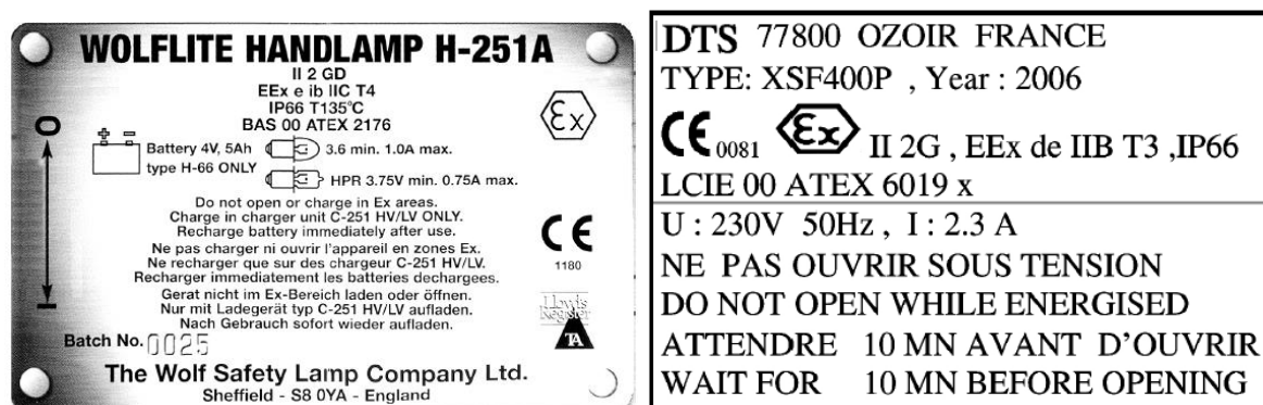
شکل ۳-۲- برچسب نمونه‌ی تجهیزات ضد انفجار
